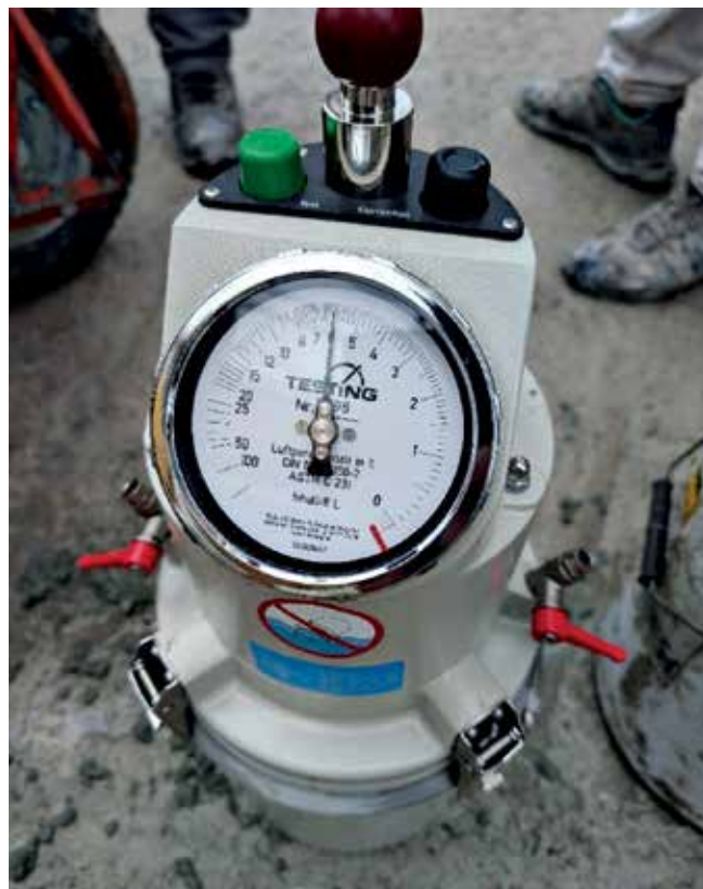
Δοκιμή αεροπεριεκτικότητας νωπού σκυροδέματος
