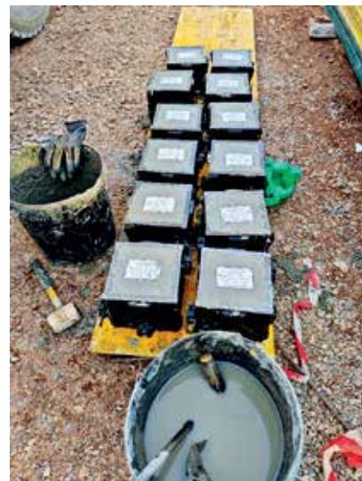
Δειγματοληψία δοκιμών σκυροδέματος
