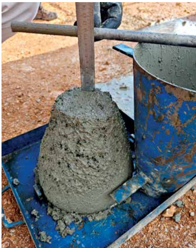
Δοκιμή κάθισης νωπού σκυροδέματος
