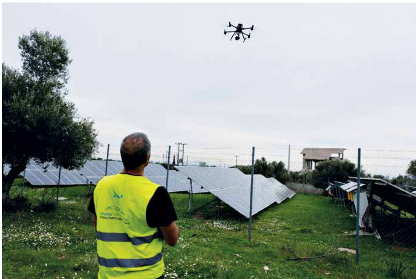
Εικόνα 1. Απεικόνιση της μεθόδου Εναέριας Θερμογράφησης Φ/Β Πάρκων με την χρήση Drone
