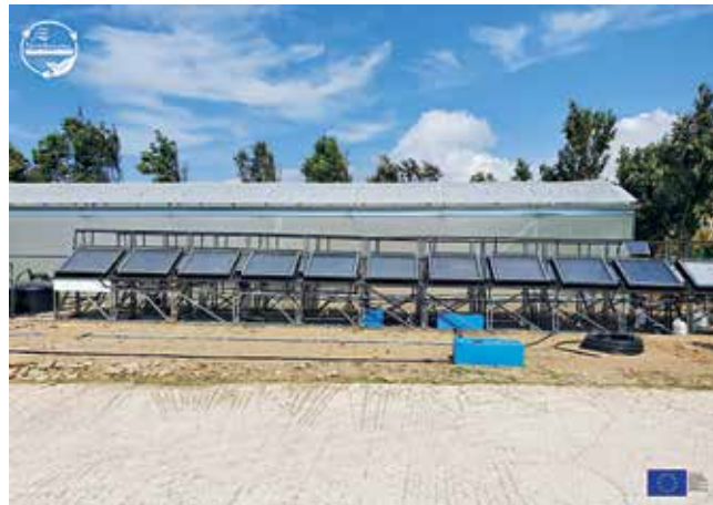
Καινοτόμο σύστημα αφαλάτωσης μέσω της ηλιακής ακτινοβολίας με τις διεργασίες εξάτμισης και συμπύκνωσης (Τήνος)
